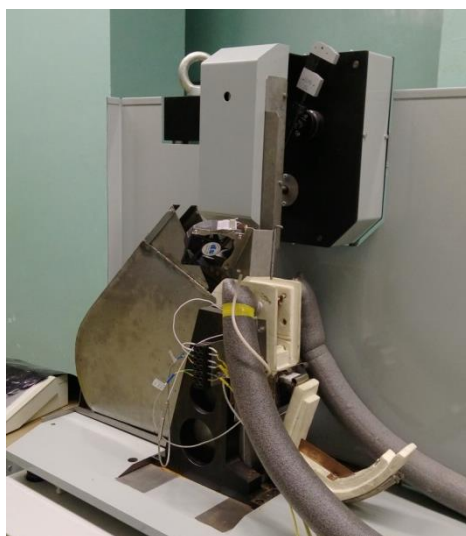
Рисунок 2.3 – Общий вид мини-копра для испытаний миниатюрных образцов на ударный изгиб
