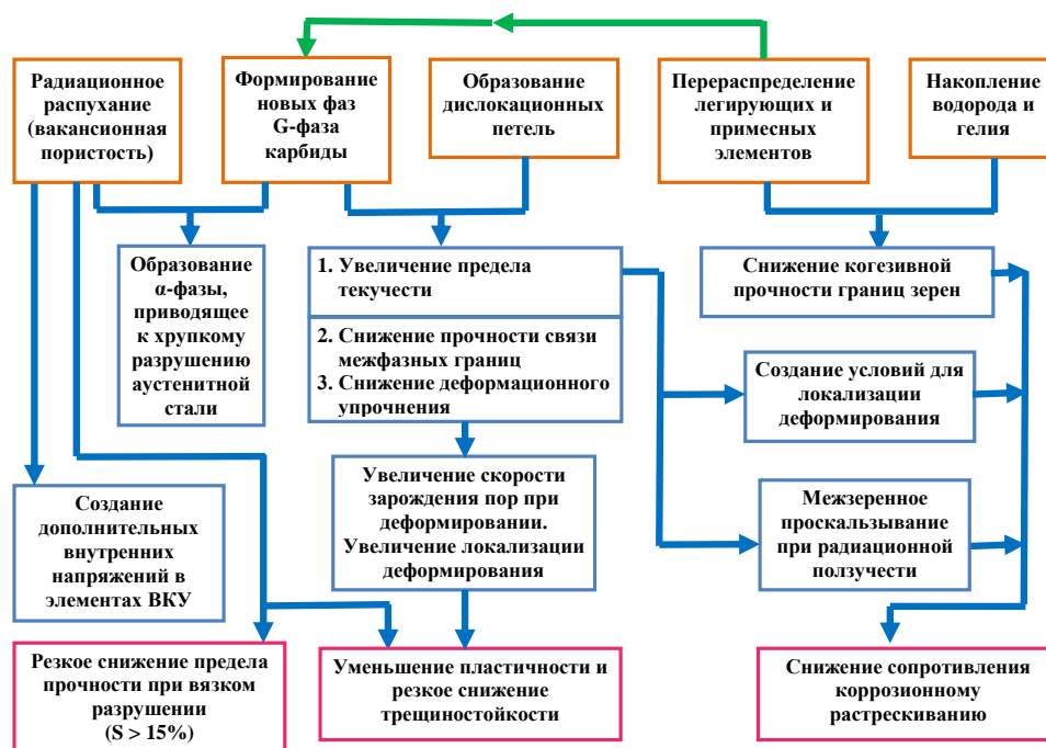
Рисунок 1.10 – Микроструктурные процессы в аустенитных сталях при нейтронном облучении и их влияние на физико-механические свойства и служебные характеристики
